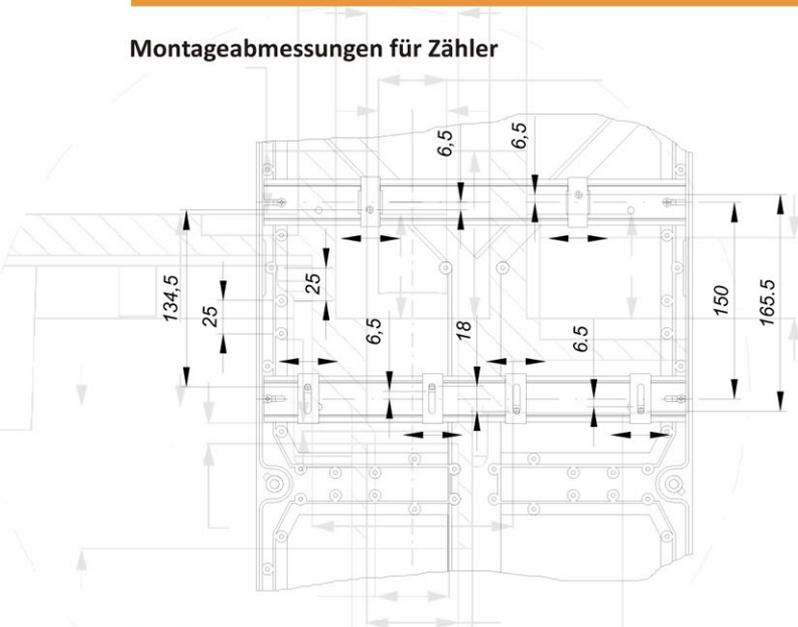
Die Zähler werden auf der Basisplatte des Schrankes, auf W-Schienen, mit M5 Spezialmutter (oder auf flachen Schienen, mit Schrauben) befestigt, mit der Möglichkeit ihre Position in 2 Richtungen einzustellen. Diese Befestigungsweise ermöglicht den Einbau von Zählern unterschiedlicher Montageabmessungen. Die untere Zeichnung gibt die Montageabmessungen der Zähler an. Der Abstand zwischen den Symetrieachsen der Ringe W ist von 150 mm.
